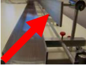
Dieses Blech wird hochkant entlang der Schiene installiert, idealerweise sollte es also die Länge der Schiene haben.
