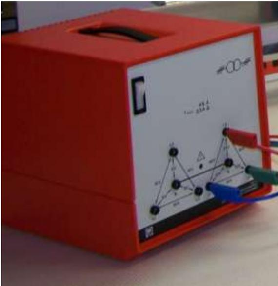
Buchsenanordnung RECHTS verwenden, links stehen „nur“ 6/10V zur Verfügung (Leistung wäre damit aber zu gering!)
