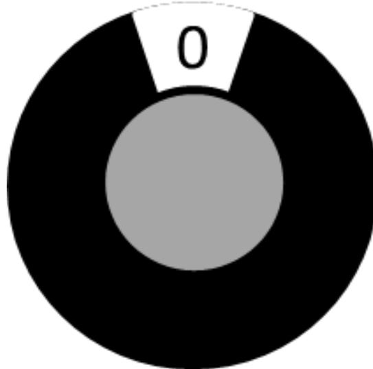
Wird ein Drehknopf mit Anzeige (wie oben rechts im Bild) benutzt, kann die Schalterstellung und damit der entsprechende Widerstandswert direkt abgelesen werden. Die Skala sollte dazu bei 0 beginnen!
