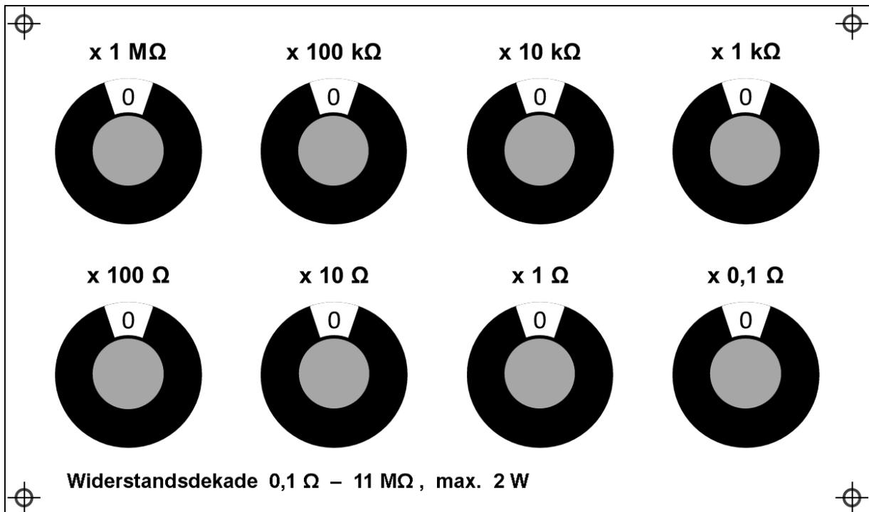
Die Anschlussbuchsen können auf der Rückseite angebracht werden. Wird auf die beiden Bereiche 0,1  $\Omega$  und 1  $\Omega$  verzichtet, passen die Anschlussbuchsen auch noch auf die Frontplatte.
