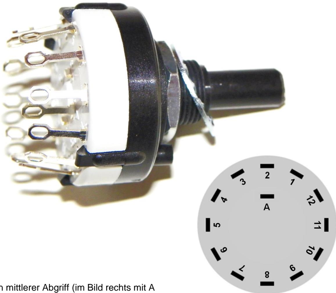
Ein mittlerer Abgriff (im Bild rechts mit A bezeichnet) wird hier, je nach Schalterstellung mit einem der zwölf Angriffe außen herum verbunden.
