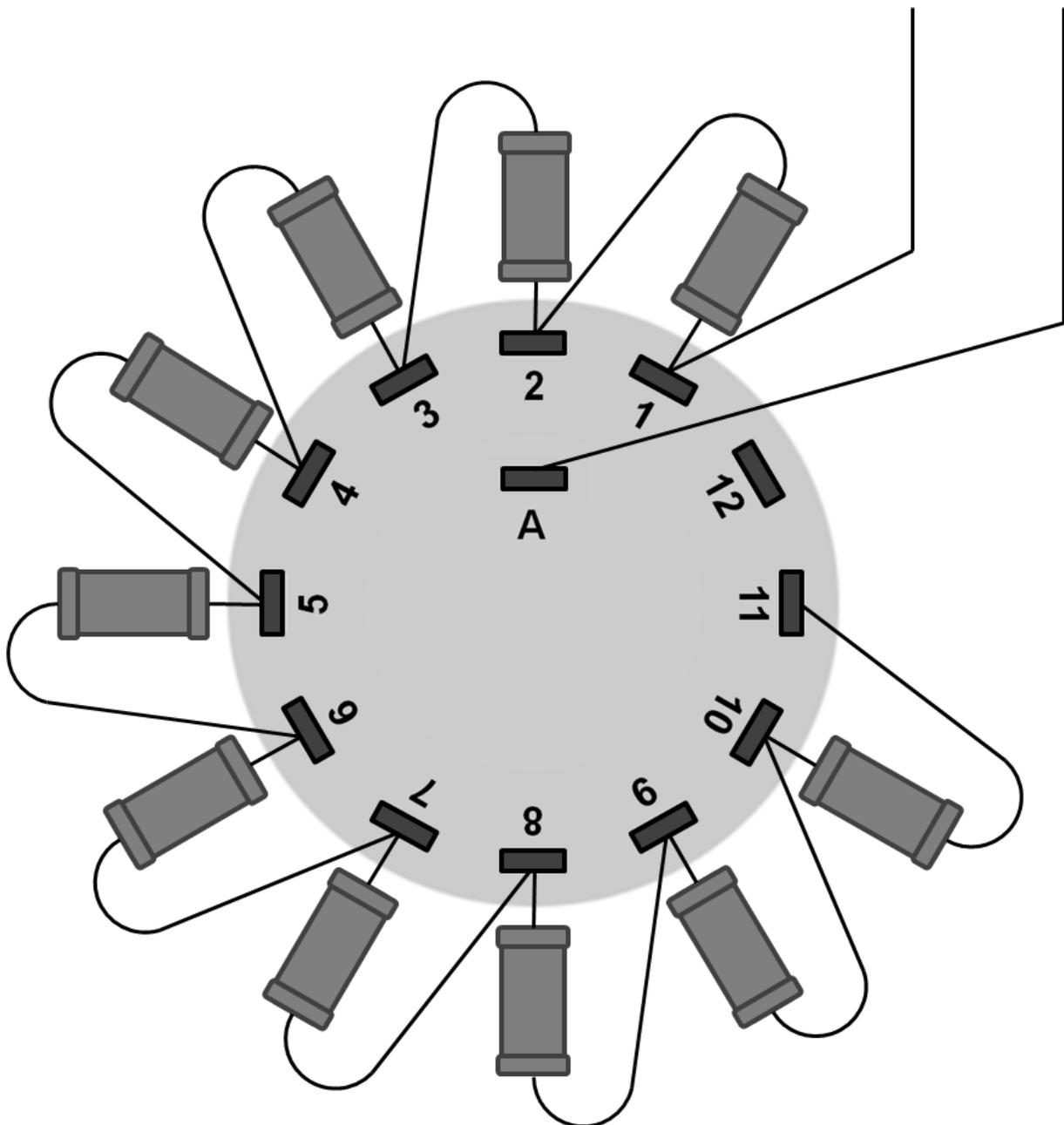
Steht der Drehschalter auf Position 1 (dann wird Kontakt A mit Kontakt 1 verbunden) misst man an den beiden Leitungen (oben rechts) keinen Widerstand, hier ist dann ein Kurzschluss, oder  $R = 0 \Omega$ .
