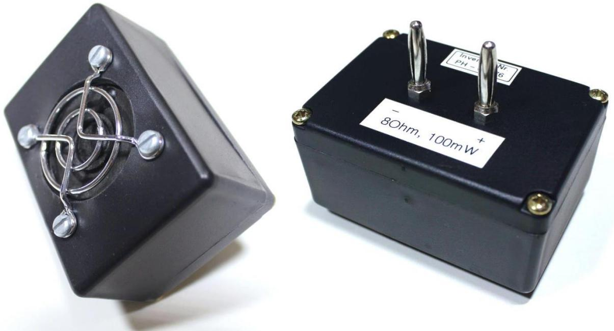
Hier wurde ein kleiner Lautsprecher in ein Universalgehäuse eingebaut und mit zwei Einbausteckern in Abstand 19 mm – kompatibel zu den Stecksystemen gemacht. Als Lautsprecherabdeckung kam hier ein kleines Lüftergitter zum Einsatz, an dessen Befestigungsschrauben innen auch gleich der Lautsprecher mit vier kleinen Krallen befestigt wurde.
