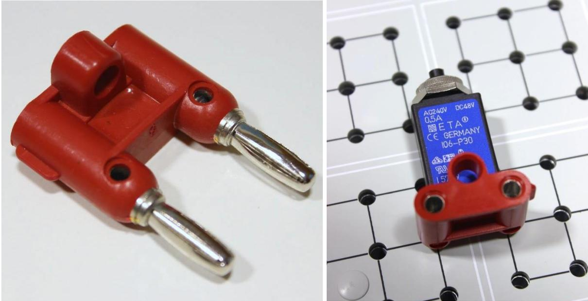
Auf diese Art und Weise konnte hier ein Sicherungsautomat in das Stecksystem integriert werden. Auch Anschlusskabel (mit Doppeladern) zum Verbinden von Stromversorgungen, Verstärkern etc. können hier recht komfortabel konfektioniert werden – aber bitte **nicht für Netzspannung**, auch wenn der Stecker, wie bereits erwähnt passt!
