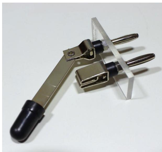
Ebenfalls mit der einfachen „Platten-Methode“ wurde hier ein steckbares Messgerät gebaut. Diesmal wurden jedoch anstelle der Einbaustecker 4-mm-Buchsen verbaut, die beidseitig offen sind. Damit kann nun entweder mit Messleitungen oder mit sogenannten Doppelsteckern (mehr dazu auf der nächsten Seite) ein Modul für das Steckbrett gewonnen werden.
