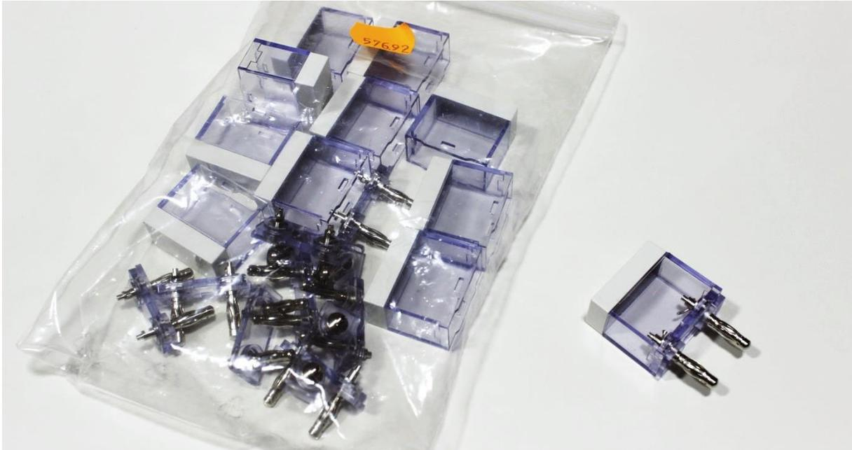
Fast alle Modulgrößen können hier als Bausatz erstanden werden. Das benötigte Bauteil muss nur noch eingelötet werden, Haube aufgesteckt und fertig ist der perfekt zum System passende Eigenbau. Die Leergehäuse gibt es als Satz (vgl. Bild oben) und sie sind vergleichsweise günstig. Ein zweipoliges Gehäuse mit Steckern im 19 mm – Abstand gibt es auch von der Firma Schnepf (Messadapter G12AU).
