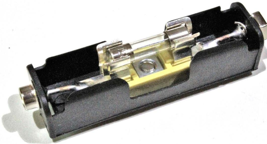
Eine richtig dimensionierte Schmelzsicherung in den Ausgang eingebaut ist zunächst keine schlechte Idee. Sie sollte lieber zu klein dimensioniert sein, als im Fehlerfall nicht auszulösen.
