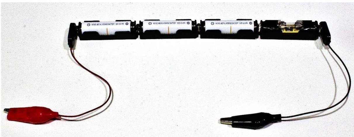
Und selbst beim Betrieb von Batterien und erst recht empfindlichen und teuren Akkus kann man diese als aktives Element in die Schaltung mit einbauen – zum Beispiel in einen zusätzlichen Batteriehalter. Die Knopf-Variante hat den Vorteil, daß man Spannungen im 1,5 V – Raster durch zusammenschalten entsprechender Anzahl Batterien leicht verändern kann.
