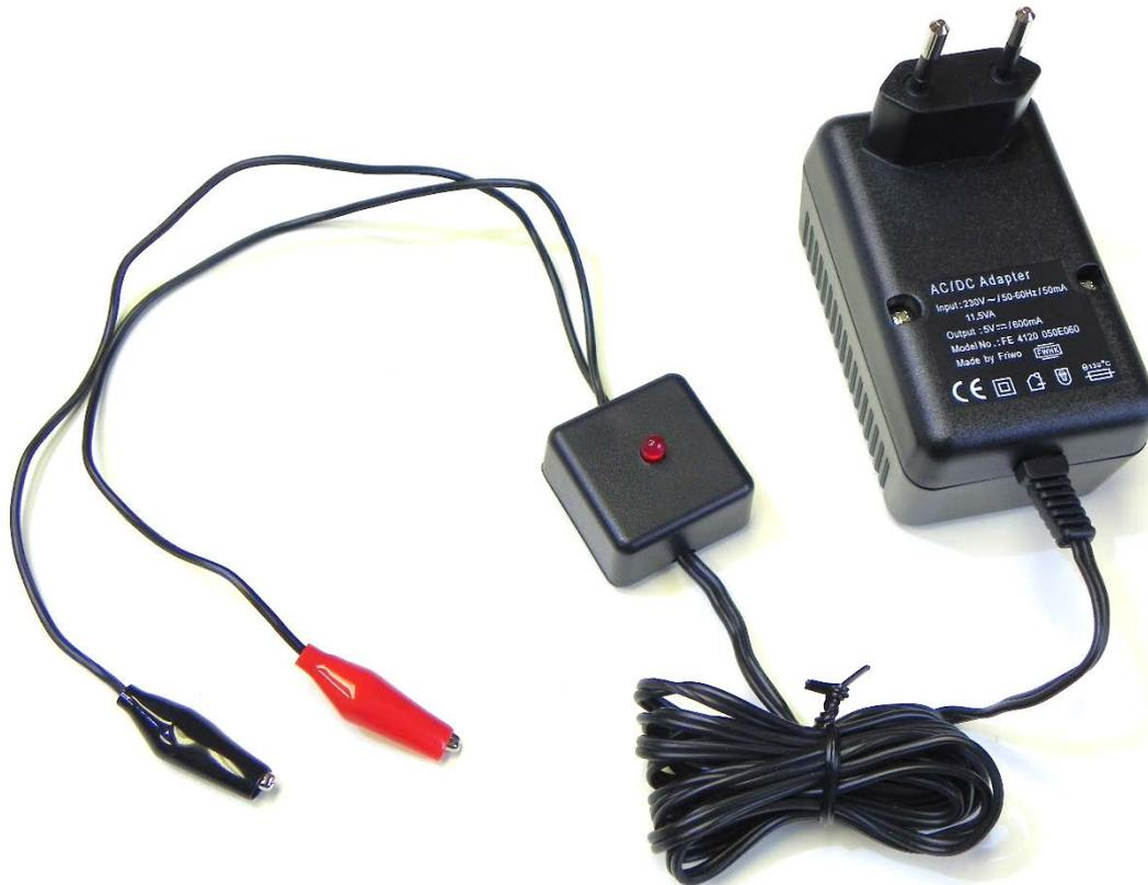
In einem kleinen Gehäuse untergebracht hat man so eine zusätzliche Kurzschluß- und Überstromsicherung mit komfortabler Anzeige. Wichtig: Das Netzteil sollte besser selber schon über einen kurzschlußfesten Ausgang verfügen, die zusätzliche Bastelei macht aus einem nicht kurzschlußfesten Transformator noch keinen kurzschlußfesten!
