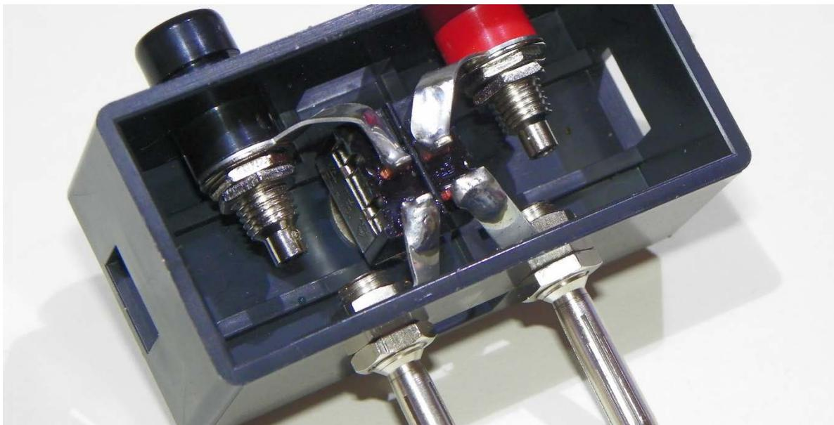
Bis zu den üblichen Maximal-Spannungen kleiner Netzteile (15 – 20 V), wie man sie üblicherweise für Elektronik-Projekte einsetzt, kann so prinzipiell (Stromfestigkeit der Bauteile vorausgesetzt) ein Schalter nachgerüstet werden. Versuchen Sie nicht, damit größere Lasten (Ströme über 3 A) zu schalten!
