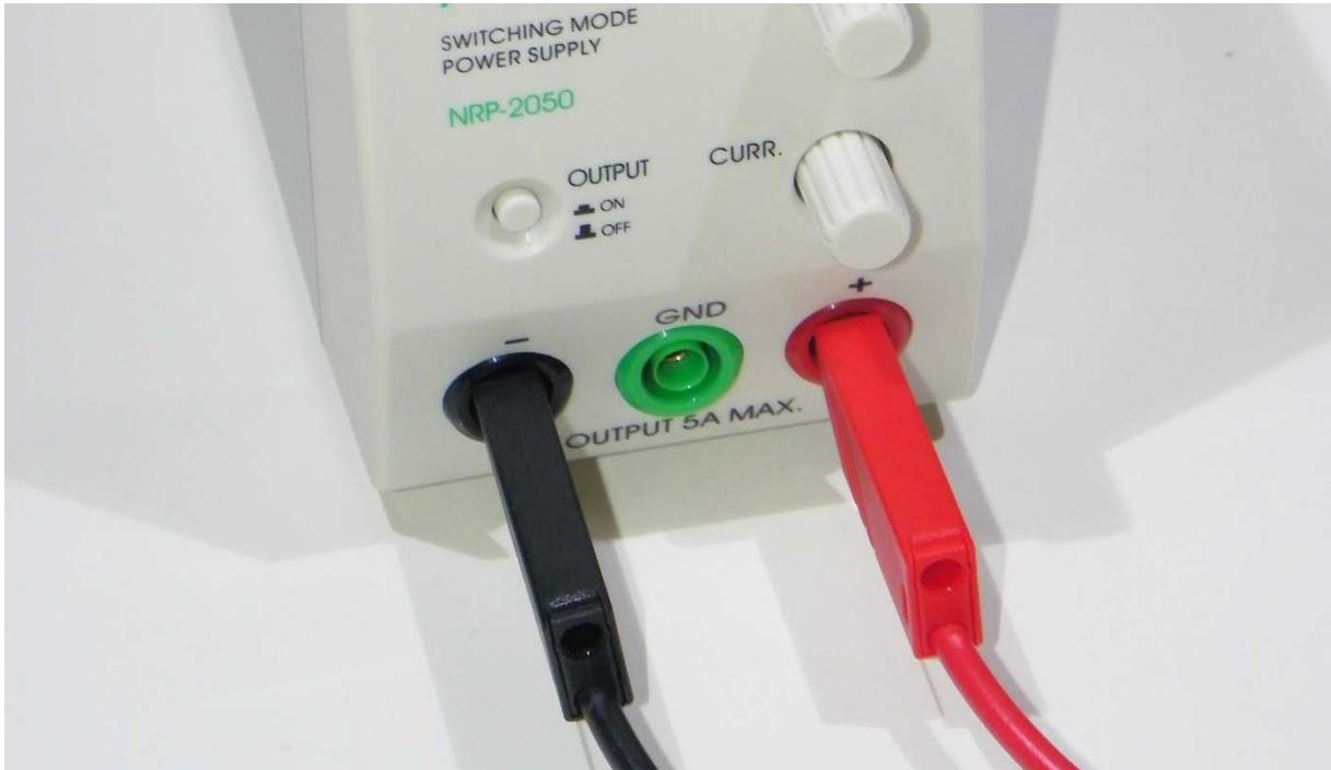
Zahlreiche aktuelle Labor-Netzgeräte besitzen einen zusätzlichen Schalter für den Ausgang. Die Idee dahinter ist, ohne die Messleitungen abzuziehen, schnell, einfach und komfortabel die Stromzufuhr unterbrechen zu können.
